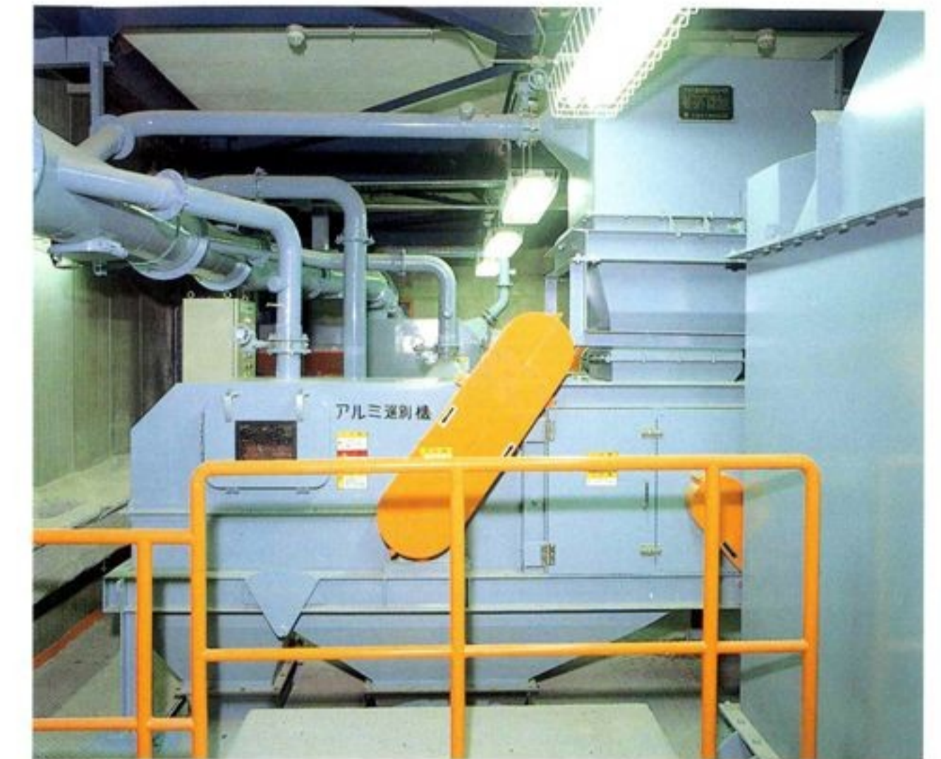
アルミ選別機 破砕されたごみの中から、磁力によってアルミを選別します。
