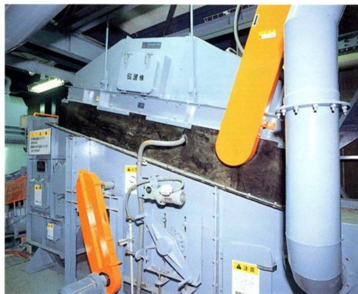
磁選機 電磁石によって、破砕したごみの中に含まれた鉄分を選別・回収します。
