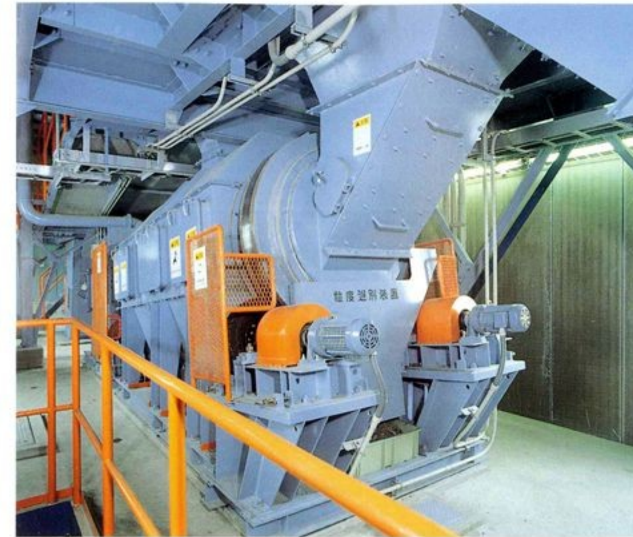
粒度選別装置 破砕されたごみを、穴の大きさが違う回転篩で、可燃物と不燃物に選別します。
