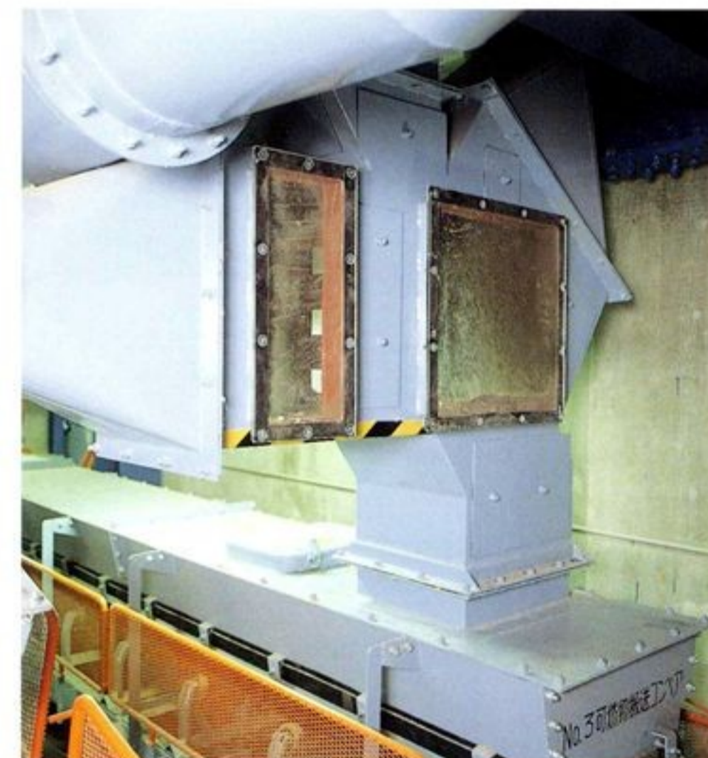
風力選別装置 可燃物の中から、風の力によってプラスチック類を選別します。
