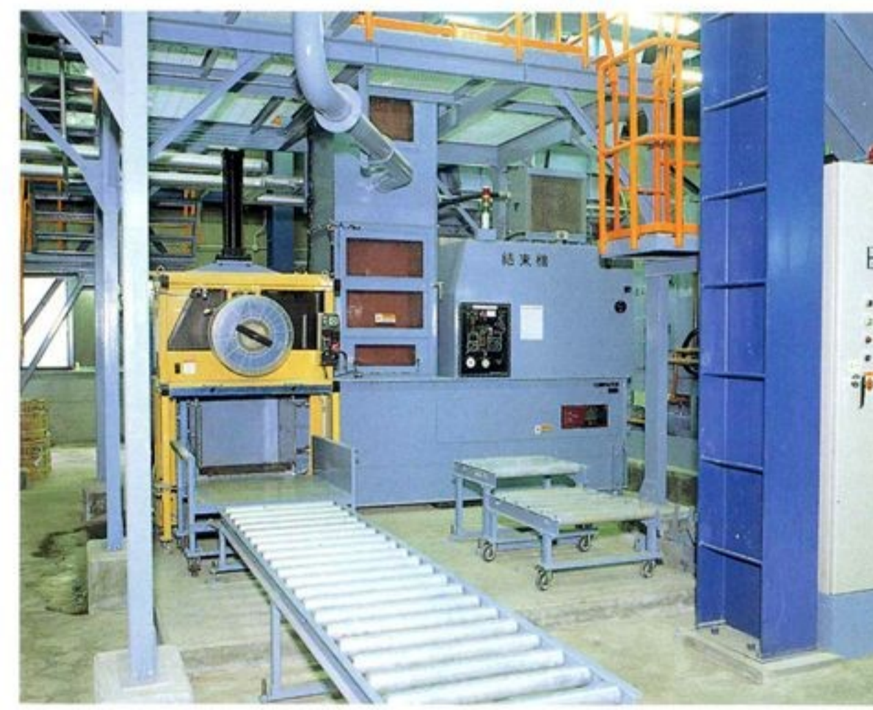
結束機 選別されたプラスチック類を圧縮して、専用テープでくくります。
